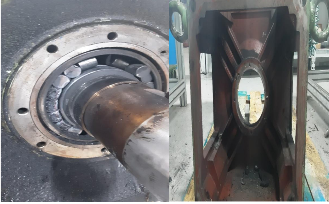
Şekil 2.4 Rulman yeri sıkı olan kapaktaki arıza
