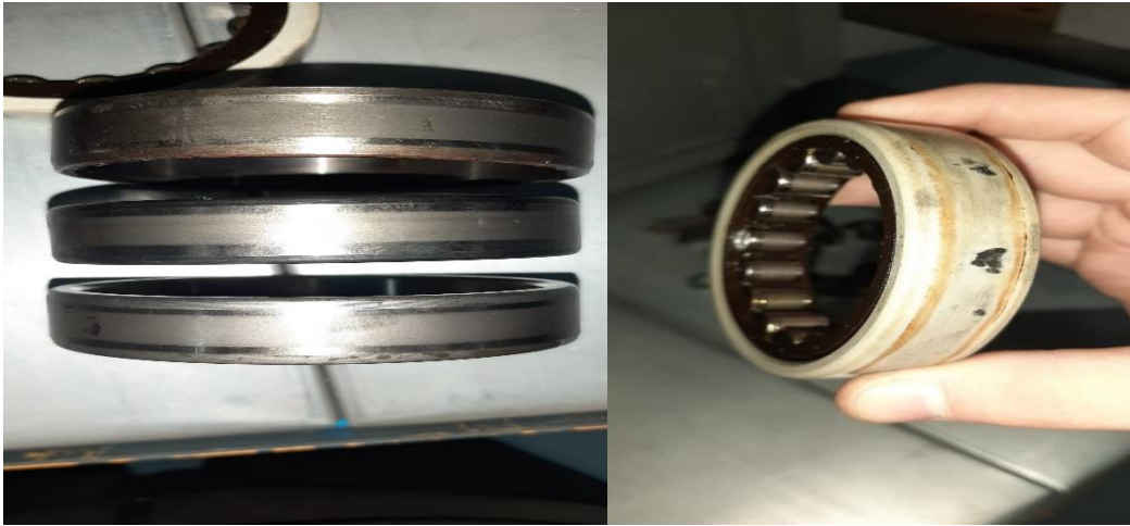
Şekil 2.3 Rulman yüzeyinde hasarlar
