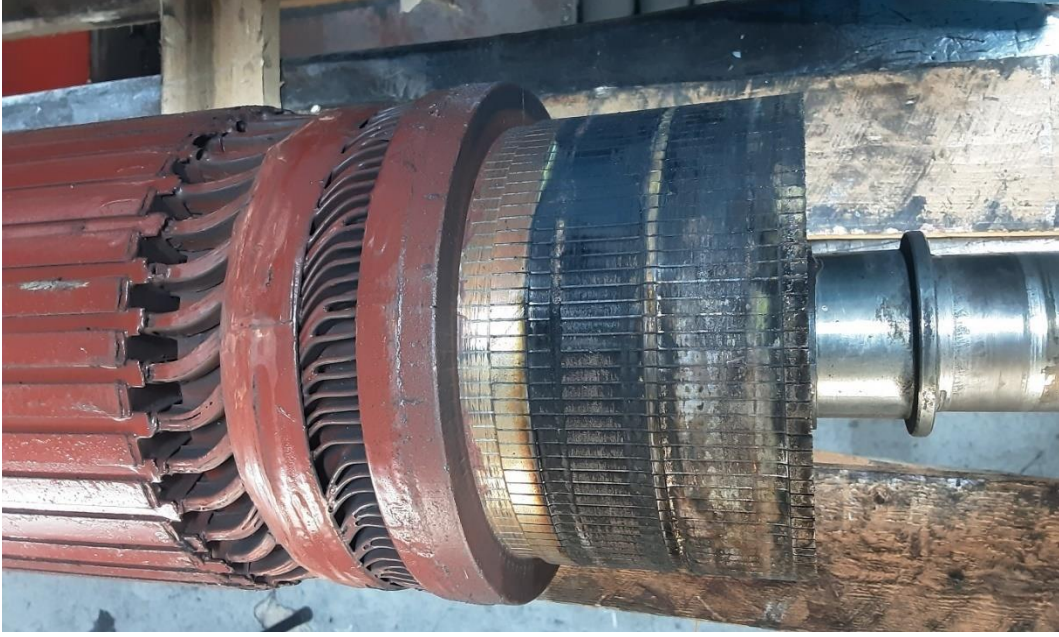
Şekil 5.25 2.kez kollektor yüzeyinde bozulmalar
