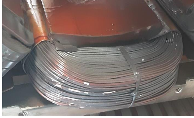
Şekil 5.17 İkaz sargılarındaki kavrulma
