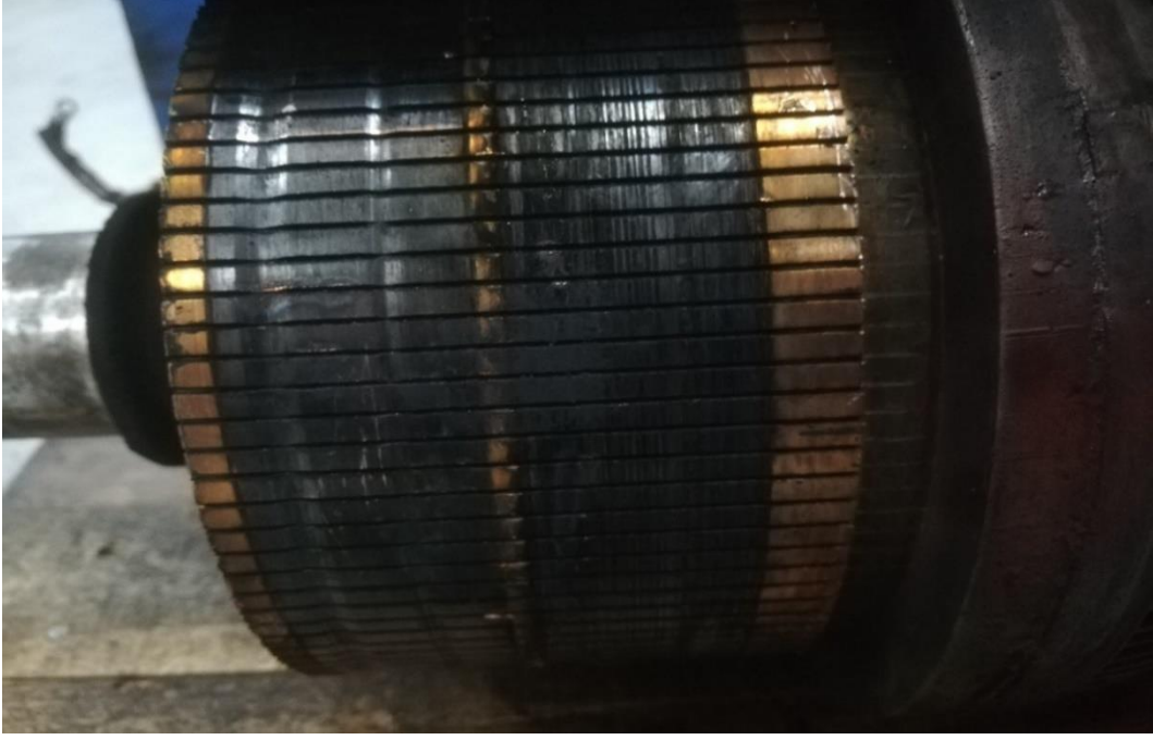
Şekil 5.24 Kollektor yüzeyinde bozulmalar
