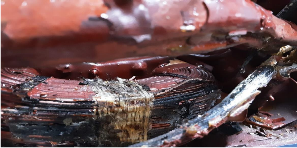
Şekil 5.22 2.kez ikaz sargılarının kavrulması
