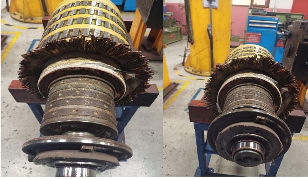
Şekil 2.13 Uygun olmayan kollektor kullanımı arızası
