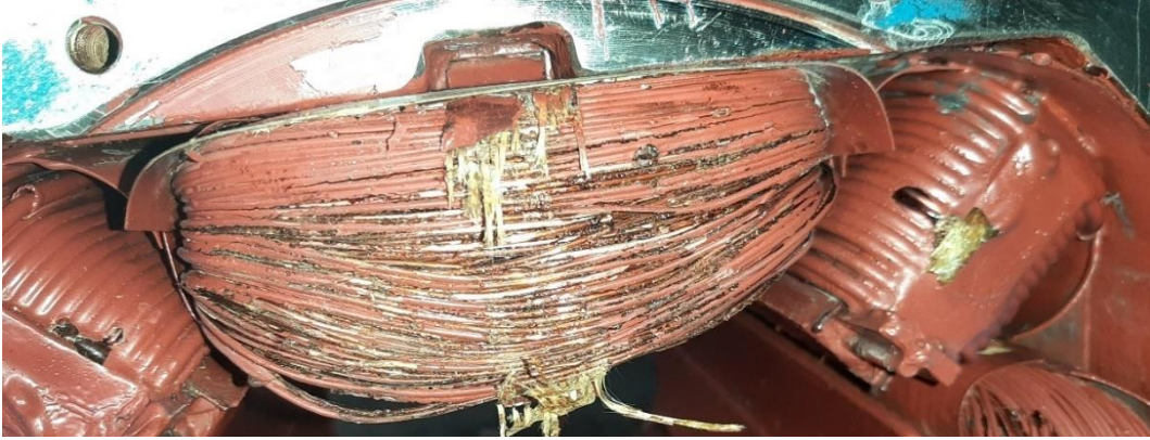
Şekil 5.21 İkaz sargılarının kavrulması
