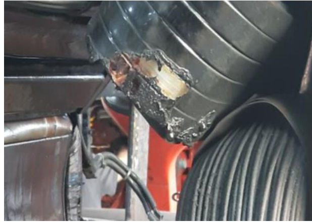
Şekil 5.18 Yardımcı sargılarındaki kavrulma
