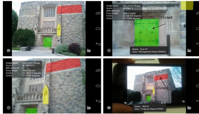
Şekil 3. 14 HD4AR uygulamasının pencere ve kapıları tanınması [124]
