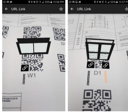
Şekil 3. 15 YBM destekli AG uygulamasında yapı bileşenlerinin görünümü [125]
