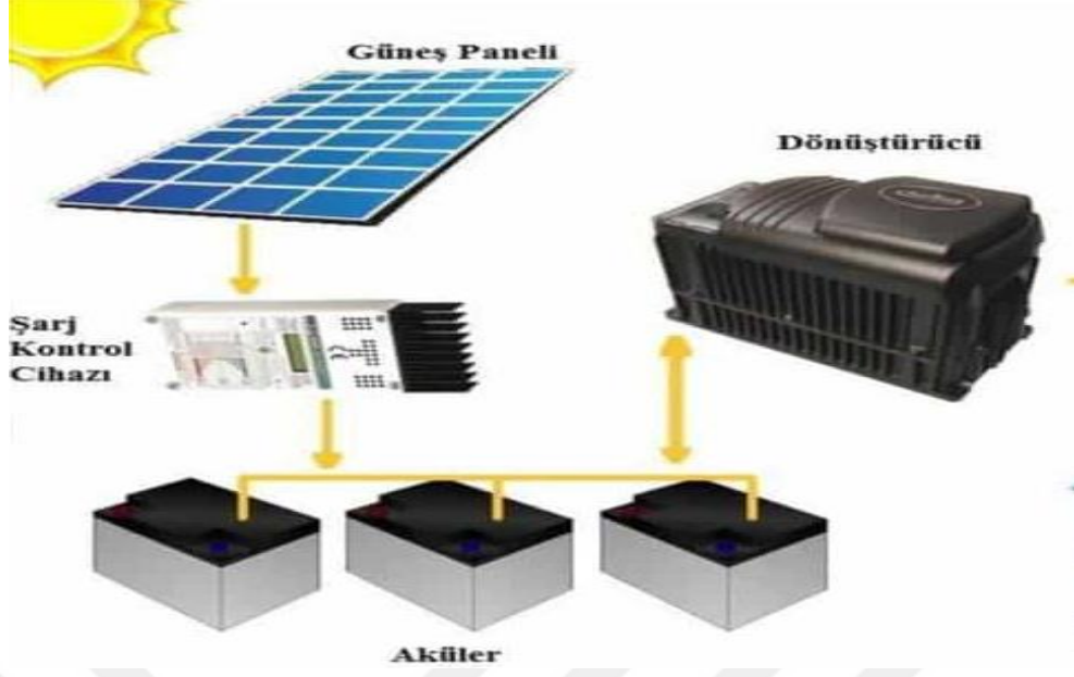
Şekil 4. 5 PV Sistem Elemanları
