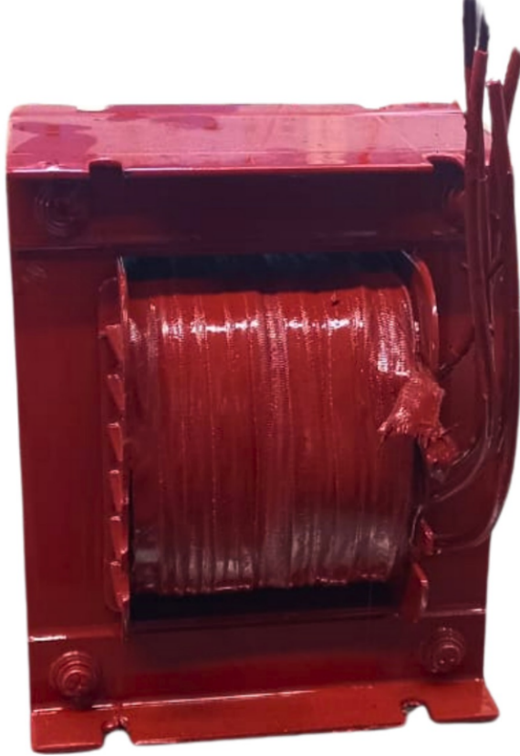
Şekil 3.11 Vernik kaplı transformatör
