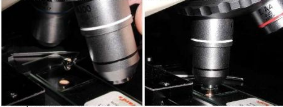
3.Adım:İmmersiyon yağı damlatılır. 4.Adım: Lam ile objektif arası şekildeki gibi olur.
