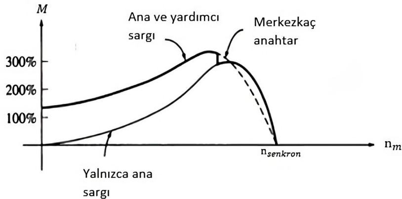
Şekil 2.6 Yardımcı Sargılı Tek Fazlı asenkron motorda net hız-moment eğrisi
