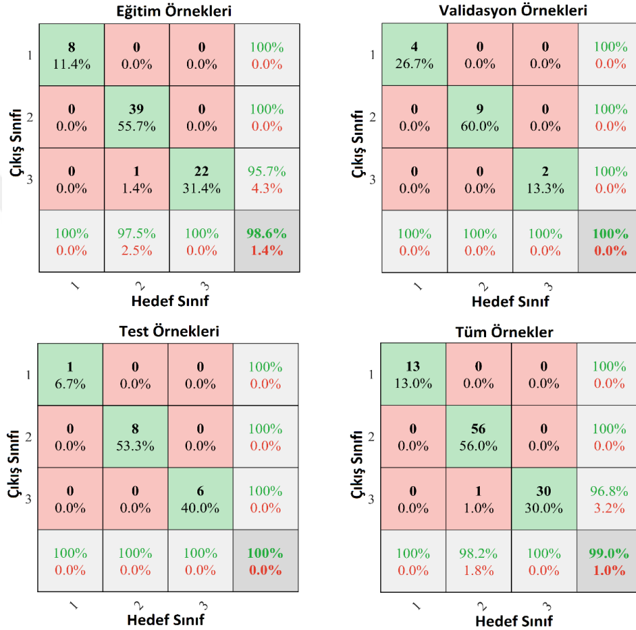
Şekil 5.11 MNF, MDF, MFL, ZC ve DASD özelliklerin kullanılmasıyla YSA'dan elde edilen doğruluk oranlarını gösteren karmaşık matrisleri
